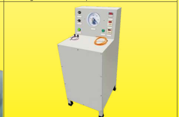
Kontrolle der Luftschalter-Betriebszyklen
