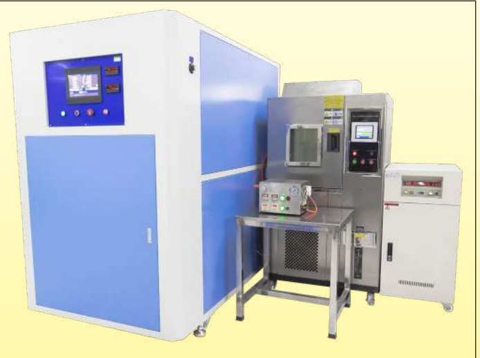
Elektrische Lebensdauer-Prüfgeräte für Luftschalter (Dient zur Überprüfung der Einhaltung der geltenden UL- und CE-Normen)
